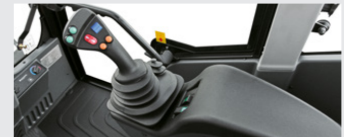
Armlehne und Joystick bilden mit dem Sitz eine Einheit, und machen alle Bewegungen des Sitzes mit. So bleibt der Fahrer auch an langen Arbeitstagen fit.
